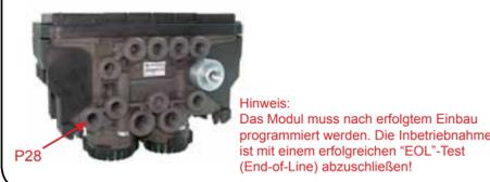
Hinweis: Das Modul muss nach erfolgreichem Einbau programmiert werden. Die Inbetriebnahme ist mit einem erfolgreichen "EOL"-Test (End-of-Line) abzuschließen!
